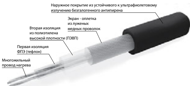
Конструкция нагревательного кабеля ELEKTRA TuffTec™
